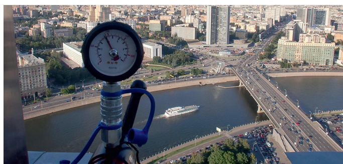
Испытание несущей способности крепления ветрозащитного остекления (гостиница «Украина»/Radisson Royal Moscow, 2010 г.)
